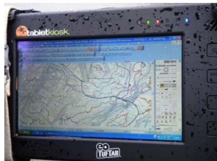
TufTab , 140x213 mm, 1,16 alt. 1,4 kg, 1,6GHZ, Windows XP Tablet, digitizer, ca. 18.000 eller 19.600 kr beroende på batteri.
